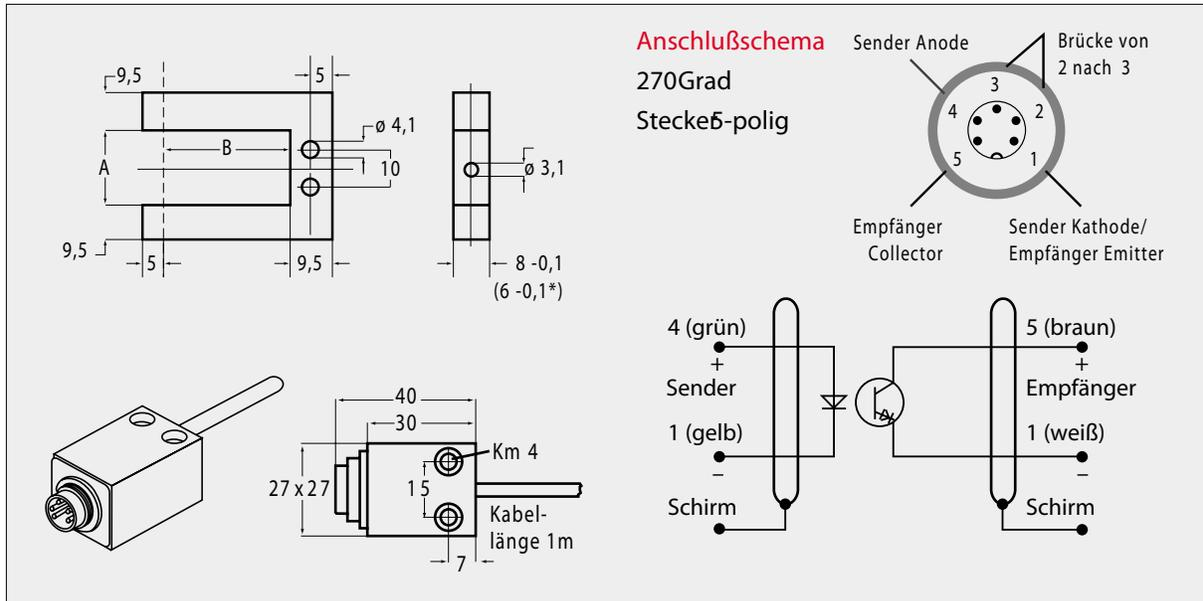
Im Lieferumfang der Lichtschranke ist ein Anschlußblock enthalten. Zum Betrieb der Wechsellichtverstärker WL3 nötig
