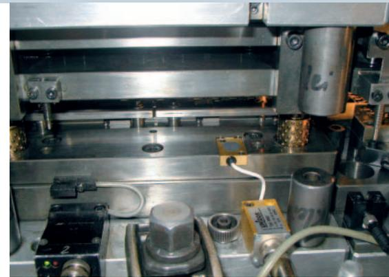
**Kompakt:** Systeme der jüngsten Generation (goldfarbene Box rechts) lassen sich – auch nachträglich – einfach in Stanzmaschinen integrieren. Links im Bild ein konventionelles digitales System auf Lichtschrankenbasis (schwarze Box)
