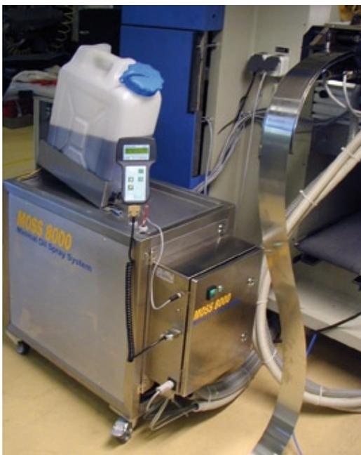
Links: Das neue Beölungssystem MOSS 8000 von Unidor ermöglicht das gesteuerte, präzise Beölen von Blechbändern, Werkzeugzonen und Werkstücken in der Blechbearbeitung und erlaubt eine Reduzierung des Ölverbrauchs um bis zu 70 Prozent. Mitte: Neben Blechbändern lassen sich auch auf einem Förderband transportierte Werkstücke beölen, zum Beispiel zur Vermeidung von Korrosion. Rechts: Dieses Two-Track-Beölungssystem erlaubt die unabhängige Schmierung zweier unterschiedlicher Bänder.
