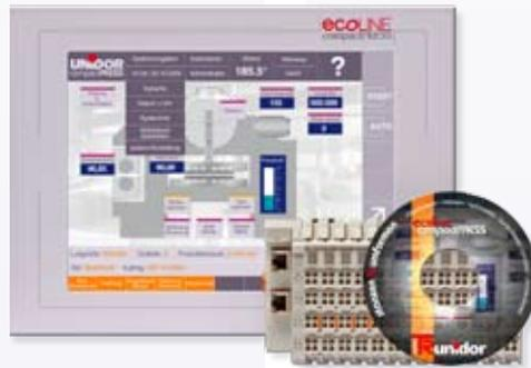
compactPRESS**ecoline** paßt überall und ist als embedded PC-System im ethercat-Netz realisiert. Über ethercat ist ecoline anwendungsabhängig, von wenigen bis beliebig vielen I/O-Klemmen, einfach skalierbar. ecoline eignet sich für kleine bis mittlere Nachrüstungs-Applikationen und ist der ideale Einstieg in die compactPRESS-Technologie.
