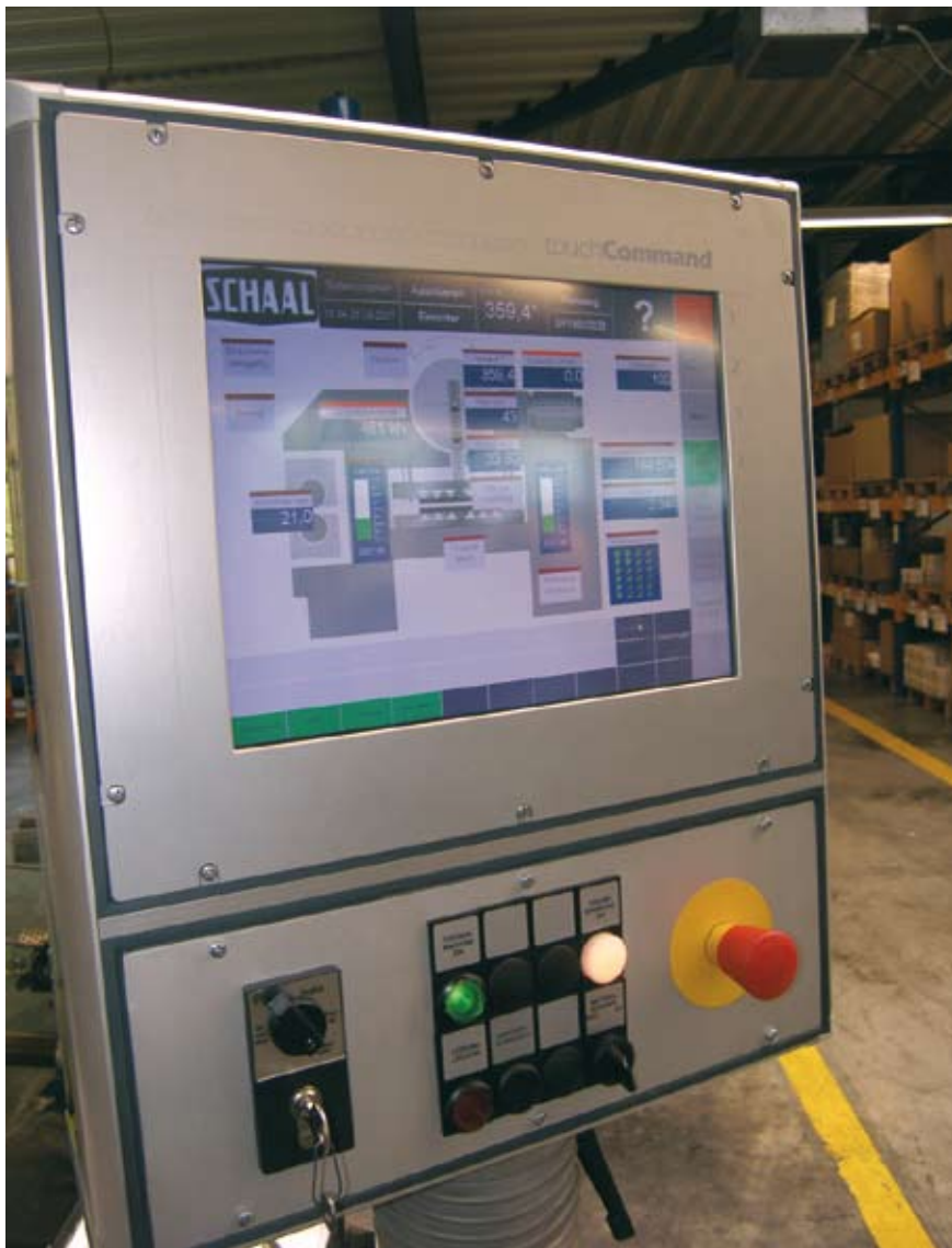
Bild 4: Mit der leicht verständlichen Bedienoberfläche des Werkzeugüberwachungssystems CompactPress hat der Werker die Maschine jederzeit im Griff
