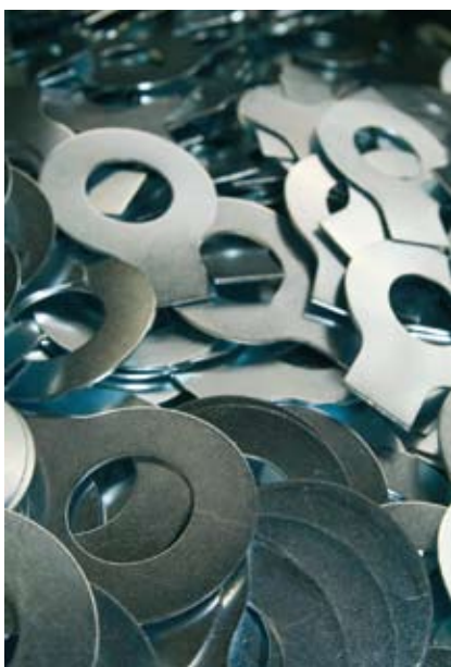
Bilder 2 und 3: Grossheim fertigt Schraubensicherungen mit Fehlerraten unter 50 ppm
