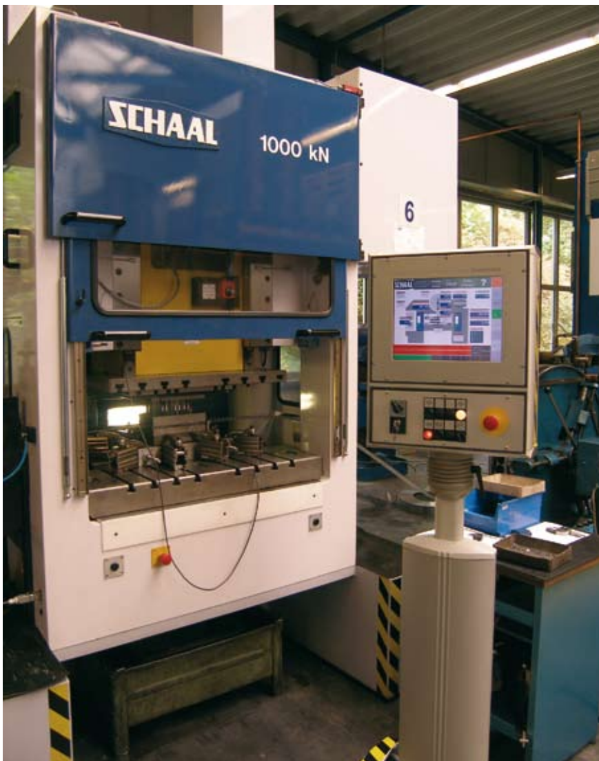
Bild 5: Die 1.000-kN-Stanzmaschine von Schaal mit integrierter Werkzeugüberwachung produziert höchste Qualität (Werkbilder: Gebrüder Grossheim, Plettenberg)
